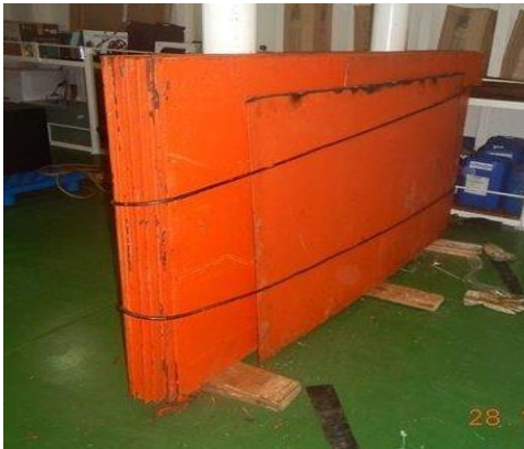
図 1: 固縛索を使って保管された鋼板の例。
